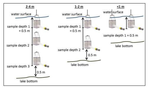
Figure 12. Schindler-Patalas sampling depths.
