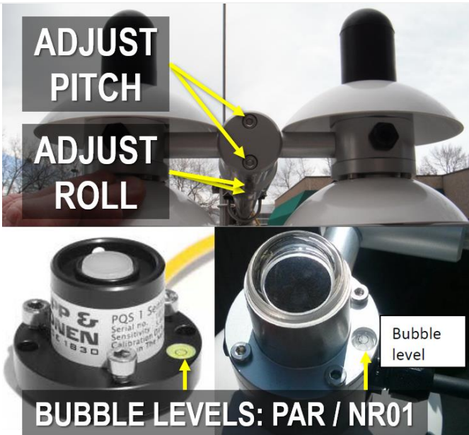
Figure 73. Sensor Leveling for Net Radiometer and PAR Sensor
