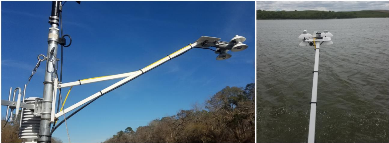
Figure 95. AIS Buoy Radiation Boom: Net Radiometer and PAR Quantum Sensor
