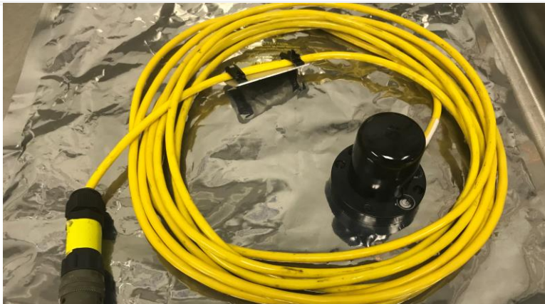
Figure 115. PAR Quantum Sensor with Black Cap over Diffuser
