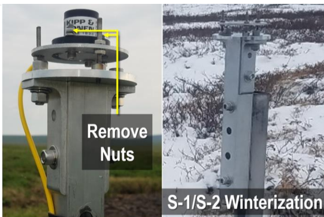
Figure 92. Remove PAR Quantum Sensor from Stream Anchor (D18 OKSR)
