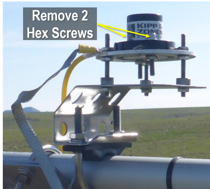
Figure 82. Remove PAR Quantum Sensor from Aquatic Met Station
