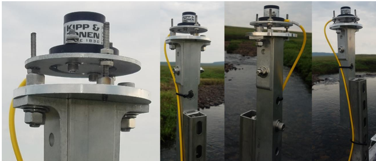
Figure 89. PAR Quantum Sensor on S-1/S-2 Anchor (D18 OKSR)
