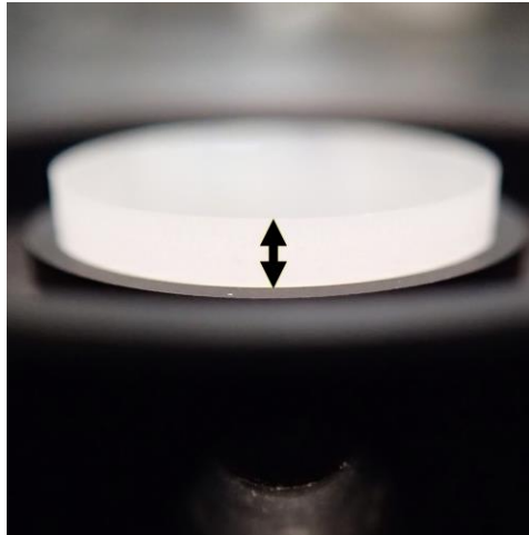
Figure 42. The vertical edge of the PAR Quantum Sensor light diffuser.
